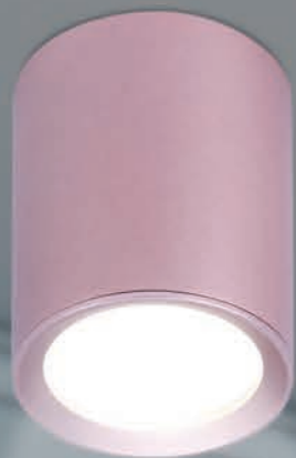
TN217 PI/S розовый/песок MR16 GU5.3/GU10 LED max 12 Вт Ø56*70
