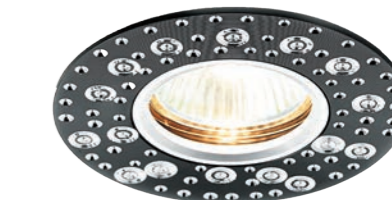
A801 BK/AL черный, алюминий MR16 GU5.3 LED max 12 Вт Ø95*20mm Ø65mm
