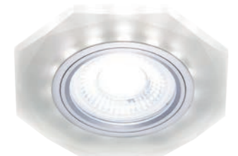
S213 WH белый, матовый MR16 GU5.3/GU10 LED max 12 Вт +3W 4200K Ø90*20mm Ø58mm
